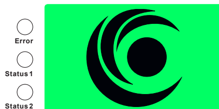
Fig. 16 : Affichage lors de la mise sous tension
