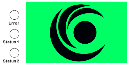
Fig. 17 : Affichage lors de la mise sous tension
